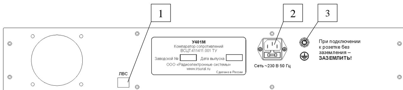
Рисунок 5 – Задняя панель блока управления и индикации
